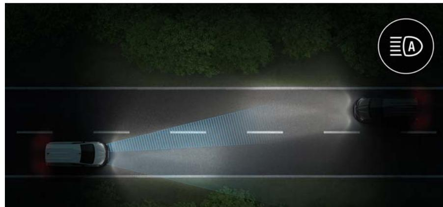
La commutation automatique des feux de route s'active automatiquement en fonction des sources lumineuses détectées et des conditions de circulation.
