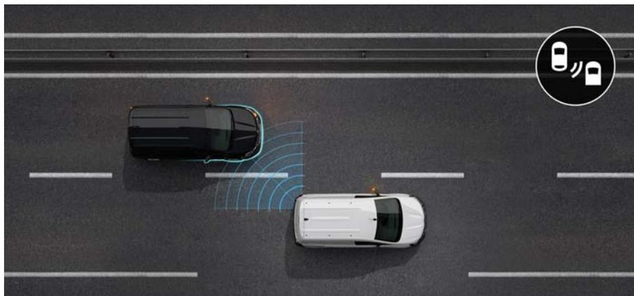
Le système actif de surveillance d'angle mort est actif entre 30 km/h et 140 km/h. Il vous alerte et corrige si nécessaire quand un véhicule s'est engagé dans la zone d'angle mort de votre véhicule.
