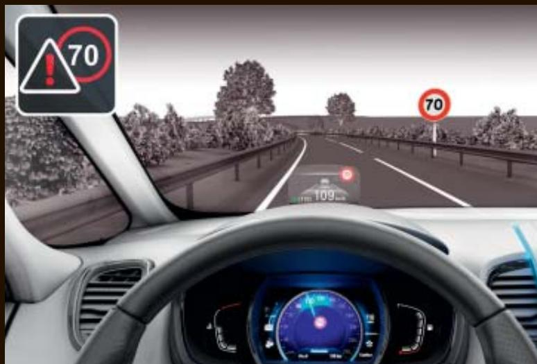
**Alerte de survitesse avec reconnaissance des panneaux de signalisation.** Le système permet d'adapter votre conduite en fonction des données de signalisation recueillies par la caméra. Une alerte supplémentaire apparaît via l'affichage tête haute si votre véhicule en est équipé.
